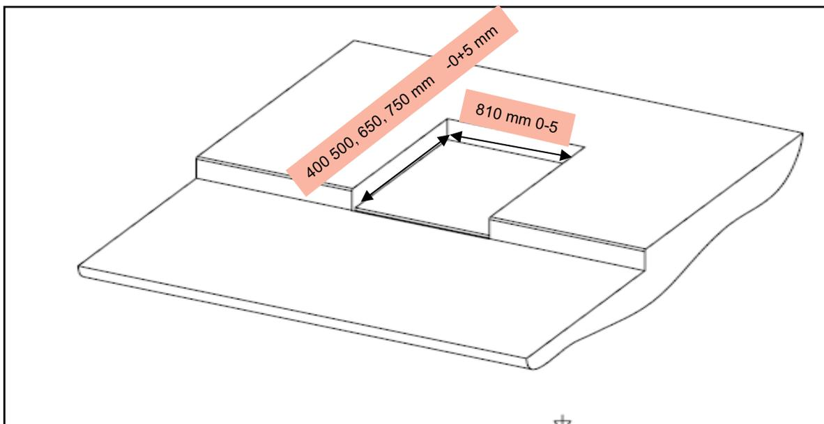
**La profondeur du décaissé doit être égale à la hauteur des flans**
